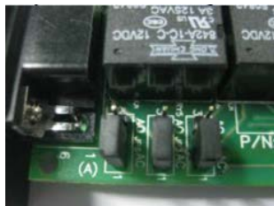
Figura 3: Config. ponticello per Normalmente chiuso (AO)
