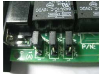
Abbildung 4: Jumperstellung Schließer (AC)
