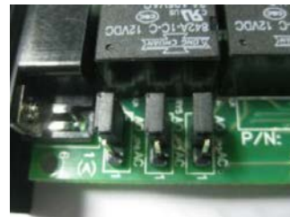
Figura 4: Config. ponticello per Normalmente aperto (AC)
