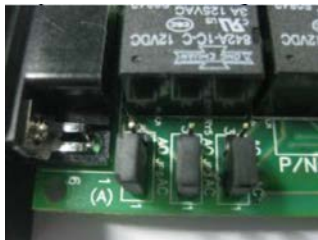
Abbildung 3: Jumperstellung Öffner (AO)
